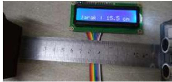
Gambar 6. Pengujian Sensor Jarak
