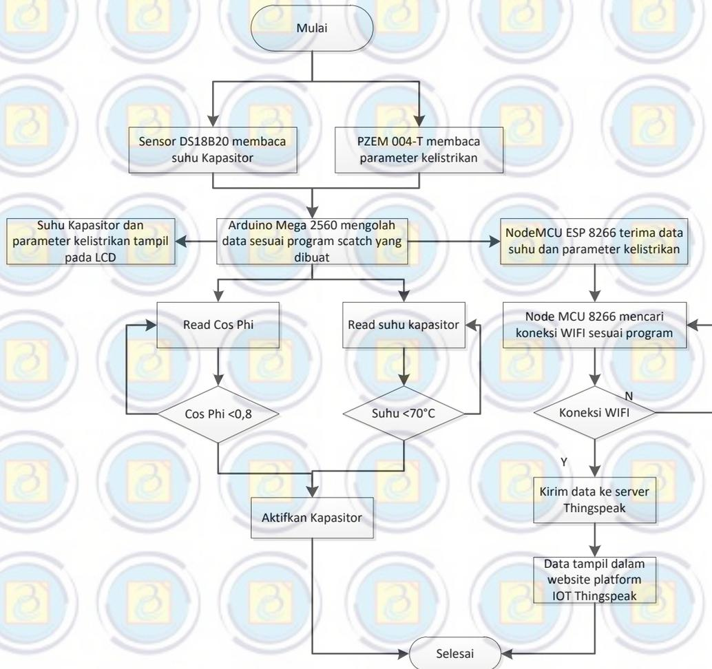
Gambar 6 Diagram Alir Program Pada Mikrokontroler.
