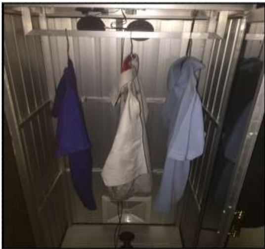
Gambar 19. Pengujian sistem pengering pakaian untuk 3 pcs pakaian
