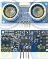
Gambar 2.1 Bentuk sensor ultrasonic HC-SR04
