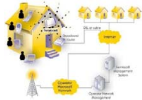
Gambar 3. Diagram umum jaringan berbasis femtocell[5]
