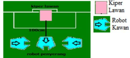
Gambar 12. Tiga kemungkinan arah yang di tuju robot pada awal pengujian
